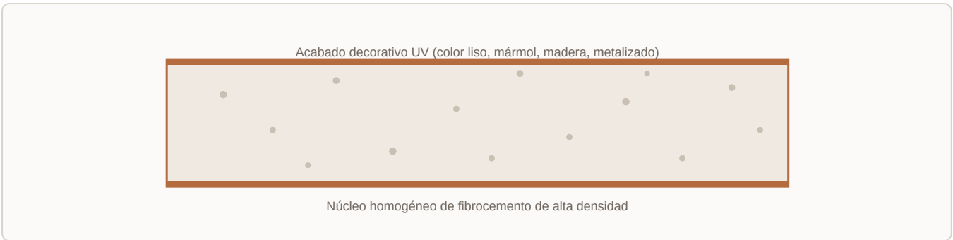
Representación esquemática de la sección de la placa; no a escala.
