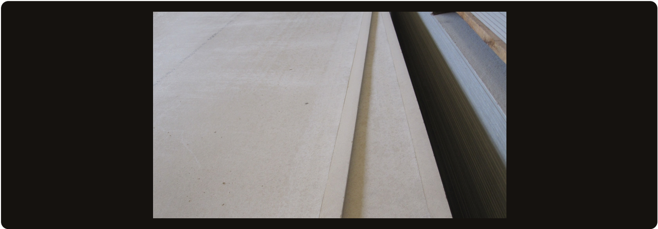
Canto rebajado (tapered edge): permite masillado continuo de la junta, igual que en una placa de yeso laminado. Una vez lijada, la superficie queda lista para pintura directa o para recibir un enchapado/laminado decorativo.
